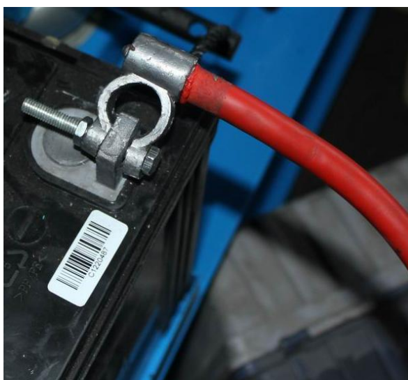
Рисунок 3. Варианты подключения клемм к аккумулятору
